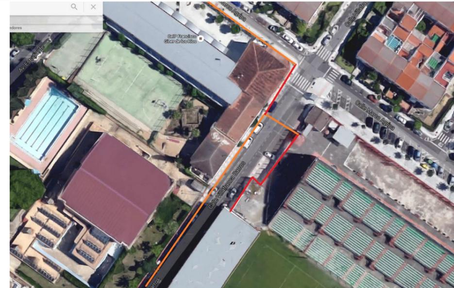
En la imagen se comprueba el trazado nuevo, utilizando canalización de alumbrado reciente (del año 2011) y la nueva a construir en rojo, tiradas cortas de enlace. El detalle de esta trayectoria se puede ver en las siguientes imágenes:
